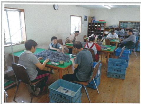
託作業では、主にリテーナ（ペアリング）積み、ダンボール容器の組み立て、チューブの取り付け等の作業を行っています。
